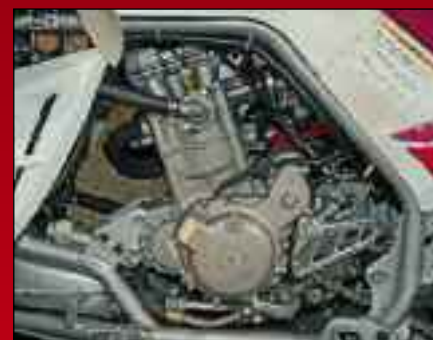
Explorer Trasher: Fuji-Motor mit 450 cm³ Hubraum
