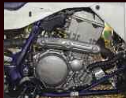
Suzuki: wassergekühlter Einzylinder mit EFI
